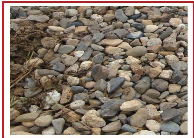
ຫີນແຮ່ ທີ່ບໍ່ສະອາດ, ມີສິ່ງເຈືອປົນ, ຂະໜາດໃຫຍ່, ແປ ແລະ ມີຫີນກາບທີ່ບໍ່ແຂງແຮງປົນ
