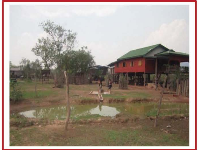
ການລະບາຍນ້ຳເສຍບໍ່ຖືກແບບຈະກາຍເປັນອ່າງຂັງນ້ຳເປັນແບບນີ້
